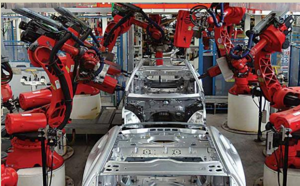
Rohbau: Bodengruppe Punktschweißen sowie Framing (Rahmen) Spannen und Zentrieren Body-In-White: Underbody & Framing Line. Locate and clamping fixture (right picture)
