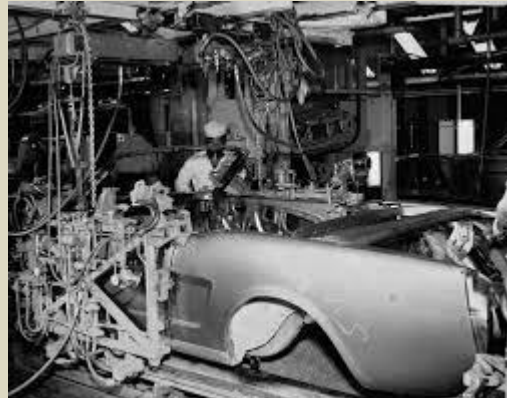
Rohbau Ford Mustang 65/66: Schweißen, Kotflügel- und Türenmontage mit Hilfe von Fixtures Body-In-White Mustang 65/66: welding, Front Fender and Door Assembly with fixture support
