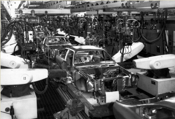
Rohbau Chevy Vega 72: einfache Linearroboter im Rohbau setzen ca. 3.900 Schweißpunkte (95%) Body-In-White Chevy Vegas 72: simple linear robots are welding 3.900 weld spots (95%)
