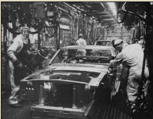
Rohbau Ford Mustang 65/66: Schweißen, Kotflügel- und Türenmontage mit Hilfe von Fixtures Body-In-White Mustang 65/66: welding, Front Fender and Door Assembly with fixture support
